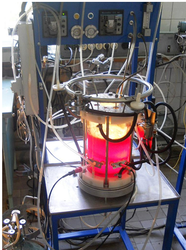
Рис. 6. Фотобиореактор на основе коаксиальных цилиндров для фототрофного культивирования микроорганизмов.
