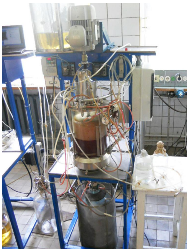
Рис. 7. Темновой биореактор АНКУМ с культурой пурпурных несерных бактерий
