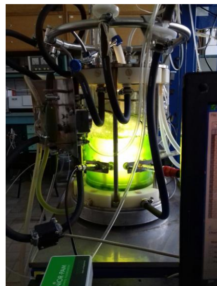
Рис. 5. Фотобиореактор на основе коаксиальных цилиндров для фототрофного культивирования микроорганизмов, сопряженный с ПАМ-флюориметром.
